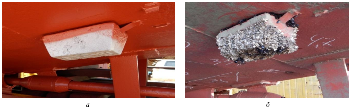
Рис. 2. Новый протектор П-КОА-5 на днище в кормовой части катера «РУМ 52-22»: а – перед началом навигации 2017 г.; б – после ее завершения
